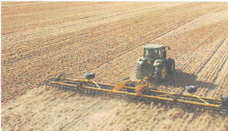
Der Striegel wurde entwickelt, um Unkrautsamen und Ausfallgetreide zum Keimen anzuregen und gleichzeitig Schnecken zu bekämpfen.
